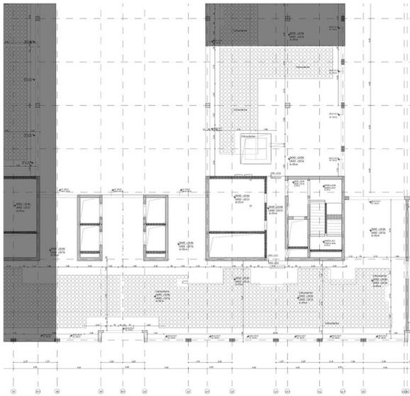
Die Experten von Cobiax erstellen unter Berücksichtigung der Deckenstatikberechnungen des Tragwerksplaners für jedes Projekt einen detaillierten Verlegeplan, um eine statische Beeinträchtigung der Flächen zu vermeiden.
