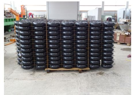
Für zukünftige Projekte und größere Produktionsvolumina wird über die Lieferung der Module getrennt in Einzelkomponenten, d.h. Kunststoffhalbschalen auf Paletten und Fixierungselemente in Bündeln, nachgedacht. Das Zusammenfügen der Halbschalen zu Hohlkörpern und die Montage zusammen mit den Fixierungselementen zu Modulen erfolgt dann wirtschaftlich, platzsparend und projektbezogen direkt vor Ort im Fertigteilwerk.
