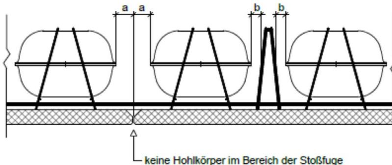
a = seitlicher Mindestabstand der Hohlkörper zur Stoßfuge (halber lichter Abstand zwischen den Hohlkörpern)
