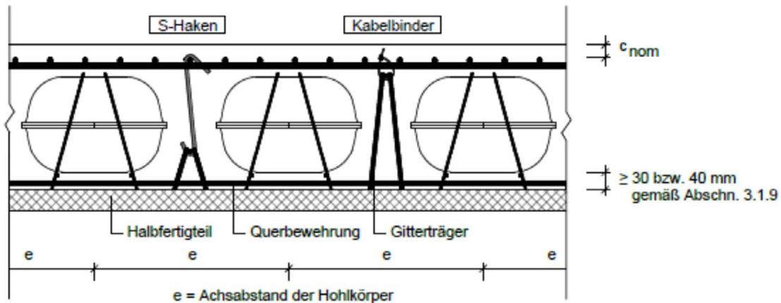
Die Betondeckung der Stoß-/Querbewehrung zur Hohlkörperoberfläche und zur Kontaktfläche des Halbfertigteiles mit dem Ortbeton (Verbundfuge) ist gemäß Abschnitt 3.1.4 und 3.1.9 zu beachten und einzuhalten.
