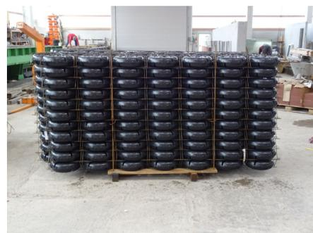
Pour les projets futurs et les volumes de production plus importants, la livraison des systèmes à corps creux est considérée séparément en composants individuels, c'est-à-dire des demi-coques en plastique sur palettes et des éléments de fixation en paquets. Le montage des demi-coques sur les systèmes à corps creux et le montage
