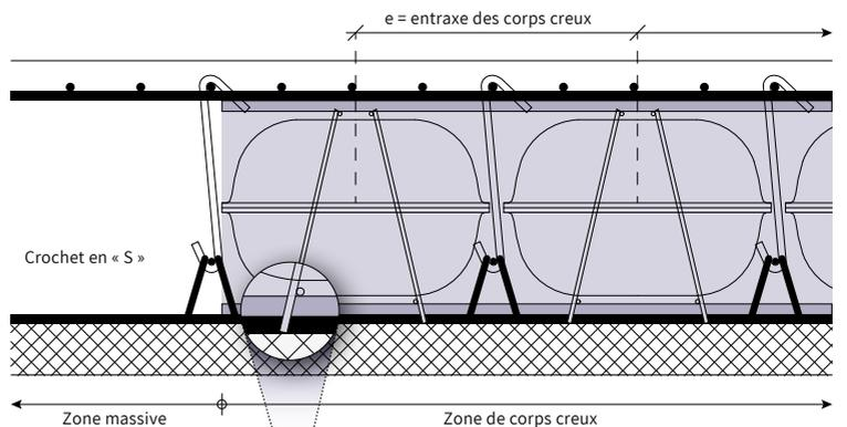
Les saillies des barres transversales peuvent être prolongées jusqu'à 6 cm afin de poser le module de corps creux directement sur l'élément semi-fini. Dans ce cas, une entretoise supplémentaire n'est pas nécessaire.
