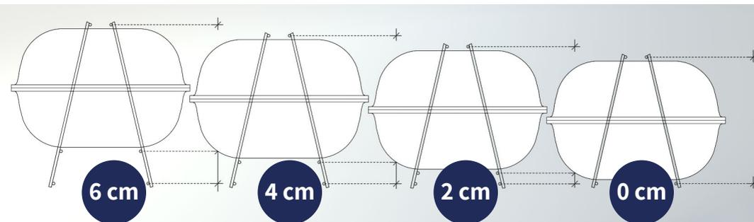
La variante 1.2 au dos de cette brochure montre une représentation schématique d'un corps creux avec une hauteur de soutien accrue dans la section transversale de la dalle.
